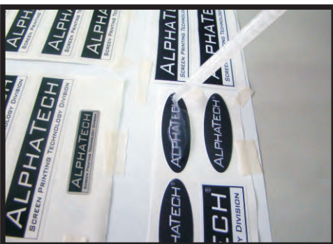
8. Aplicar a resina nos autocolantes. Deixar secar durante 4 a 5 horas num local quente e seco. Aplicar calor caso apareçam bolhas de ar.
