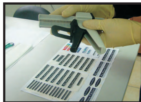
3. Colocar o pistão na pistola com as ranhuras viradas para baixo
