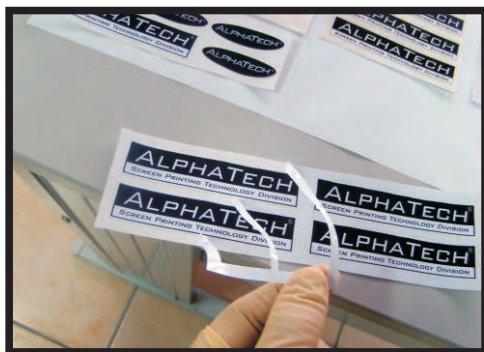
1. descolar o autocolante em excesso à volta das impressões
